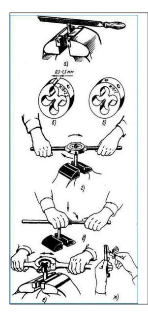
Закрепить стержень в тисках вертикально на 20 – 25 мм больше длины нарезаемой резьбы.
