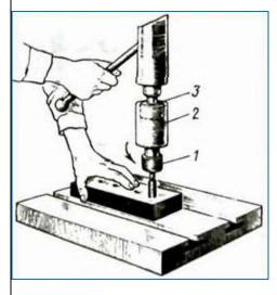
Подготовить заготовку к нарезанию резьбы. Определить по чертежу диаметр и систему резьбы и длину нарезаемой части.
